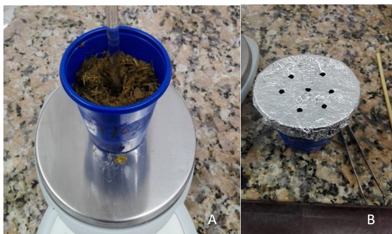
Figura 3. Envase con la materia fecal para cultivo ya pesada y con la columna de aire en el centro (A). Envase tapado con papel aluminio (B). Fuente: elaboración propia.
